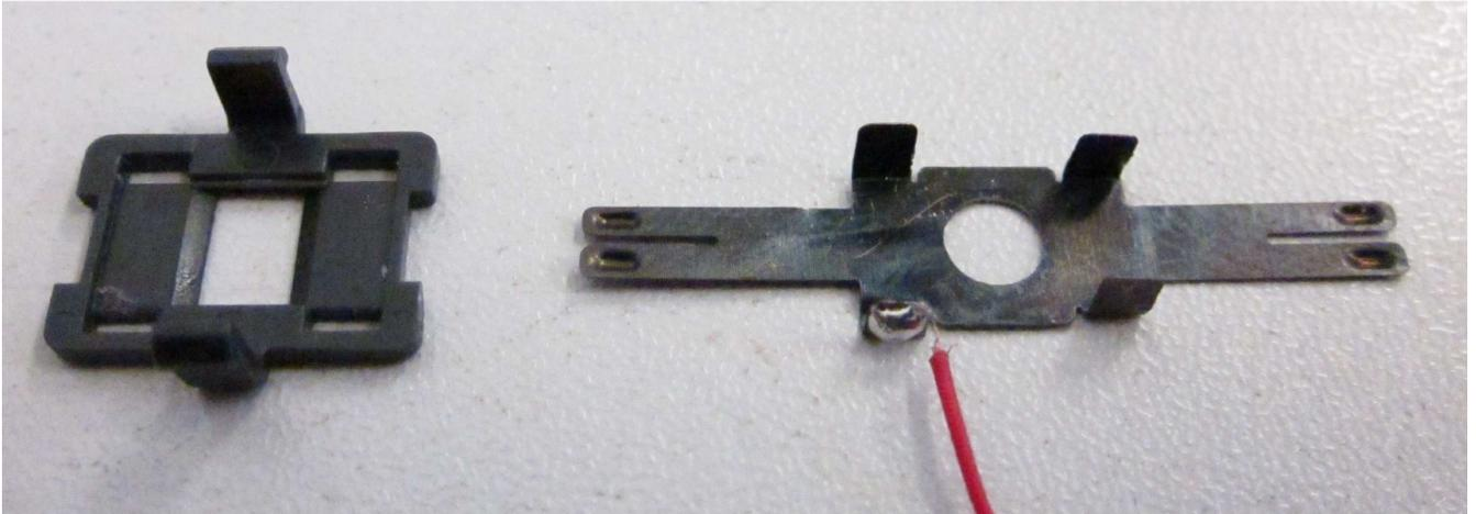
**5. Achsschleifer von der Halteplatte lösen
