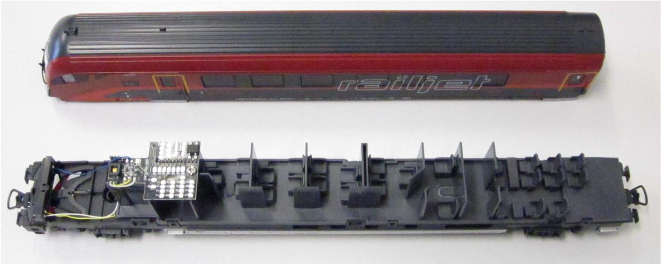
**1. Gehäuse vom Chassis lösen**
